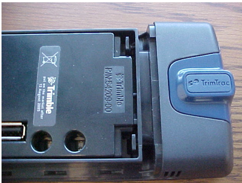
Рисунок 22. Неправильно установленный Конфигурационный модуль. Верхняя сторона не защелкнута.
