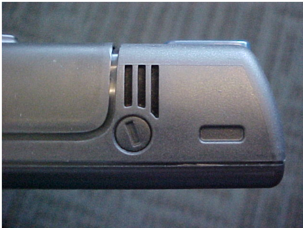
Рисунок 7. Винтовой держатель над RF разъемом внешней GPS антенны.
