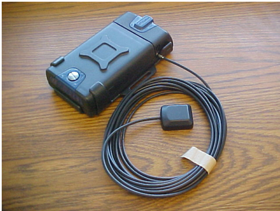
Рисунок 9. Внешняя GPS антенна, соединенная с TrimTrac Pro
