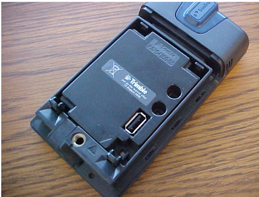
Рисунок 3. Конфигурационный модуль, установленный в TrimTrac Pro
