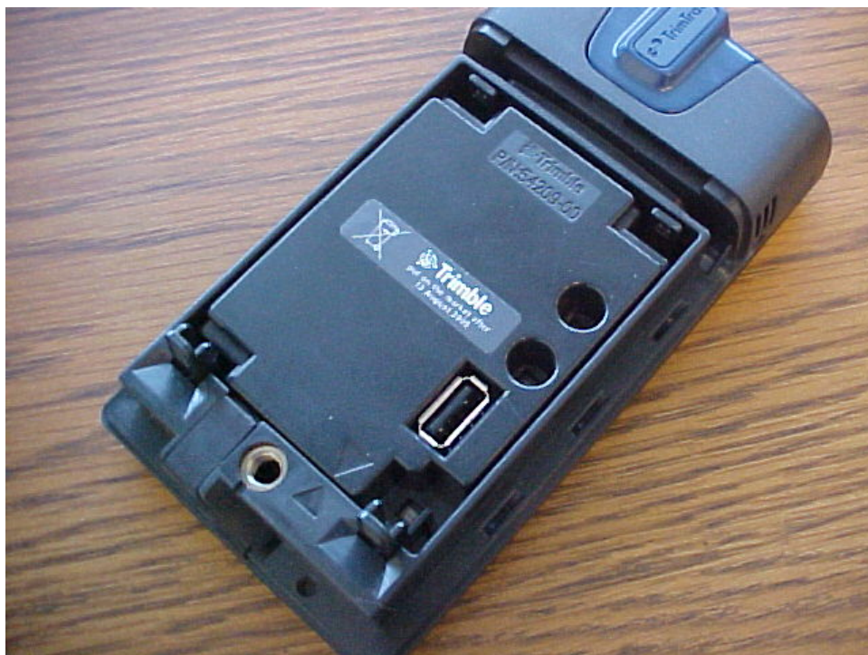
Рисунок 21. Правильно установленный Конфигурационный модуль.
