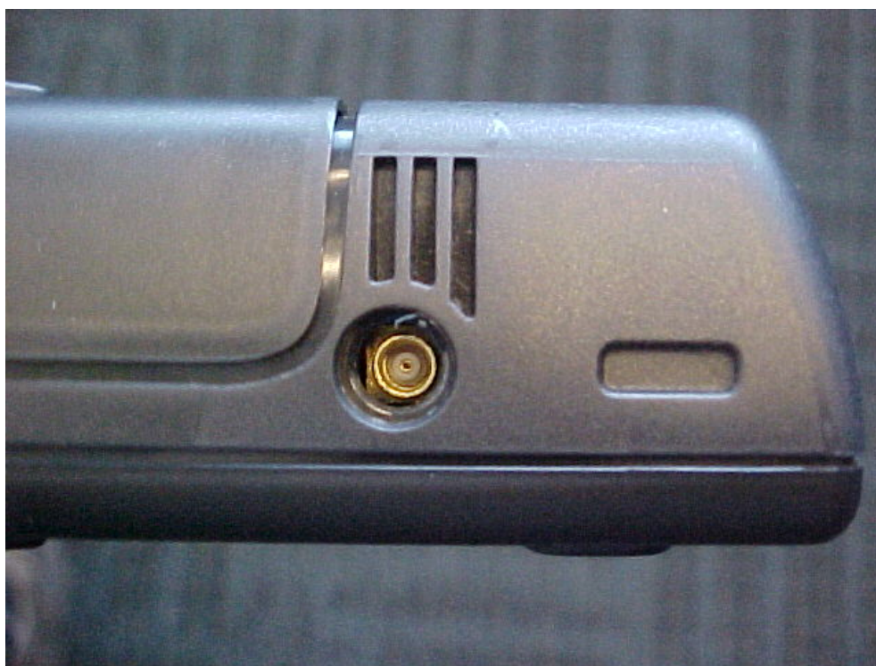
Рисунок 8. RF разъем внешней GPS антенны.
