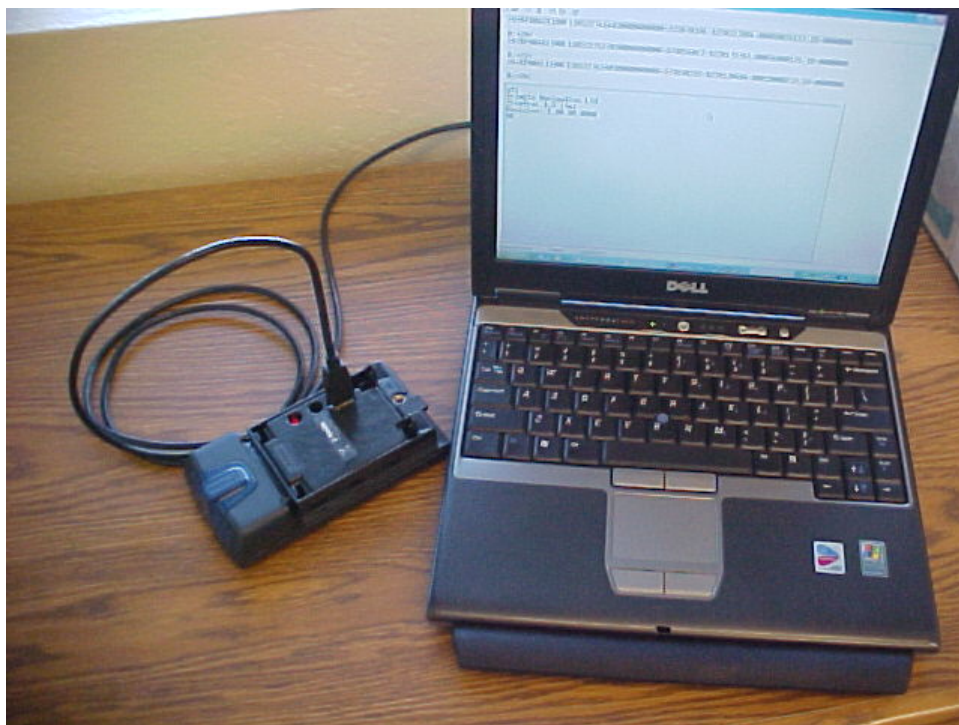
Рисунок 23. TrimTrac Pro присоединен к ПК через Конфигурационный модуль и кабель USB типа A-to-A.
