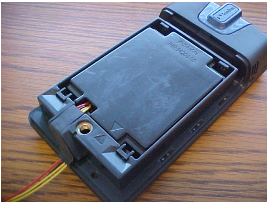
Рисунок 4. Автомобильный адаптер, установленный в TrimTrac Pro
