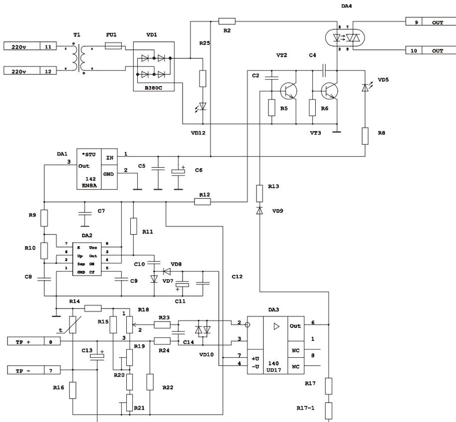
Рис.3. Регулятор температуры МикРА – А10. Схема электрическая принципиальная.
