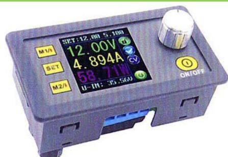
**Примечание:** Вы должны убедиться, что входное напряжение в 1.1 раз выше выходного напряжения. При длительном работе, на мощности близкой к максимальной, необходим принудительный отвод тепла.
