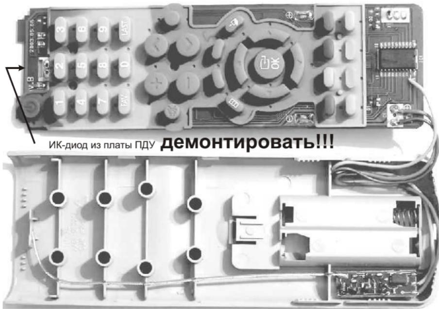
Передатчик фиксируется двухсторонним скотчем, который прилагается в комплекте.
